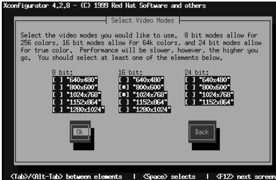
Potete scegliere modalità a 8 o a 24 bit, in funzione della potenza del vostro computer e di quanti colori volete visualizzare. In ogni modo troverete un elenco di possibili scelte; utilizzando il tasto [Tab], posizionate il cursore e selezionate la risoluzione premendo [Space].
